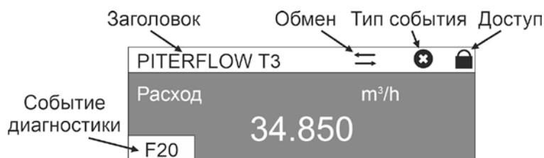
Рисунок 2.10. Общая структура экранов дисплея
