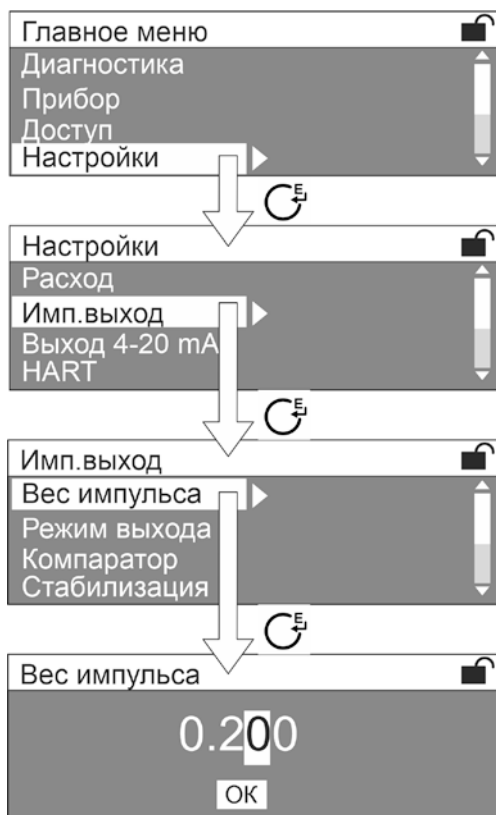
Рисунок 2.20 Редактирование значения параметра
